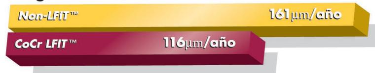
**Figura 3** Las cabezas LFIT™ demostraron una reducción del 28% en el desgaste lineal sobre las cabezas de CoCr
